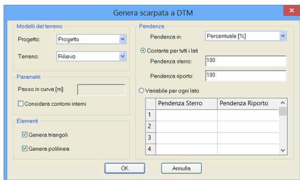
Nel momento in cui si seleziona il punto (828) compare la finestra “Genera scarpata a DTM” in cui indicare la Pendenza sterro a 100 e la Pendenza riporto a 100; premere OK e verificare lo scavo creato.
